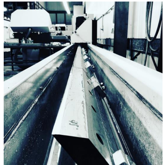
Schleiflängen bis 4500 mm. Alle Messer werden bei Thaa AG (sofern üblich) nach dem Bearbeiten entmagnetisiert und sauber abgezogen
